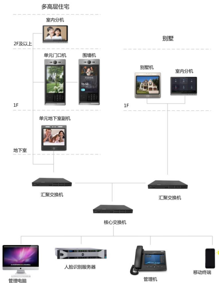
图 2-5 可视对讲系统结构
